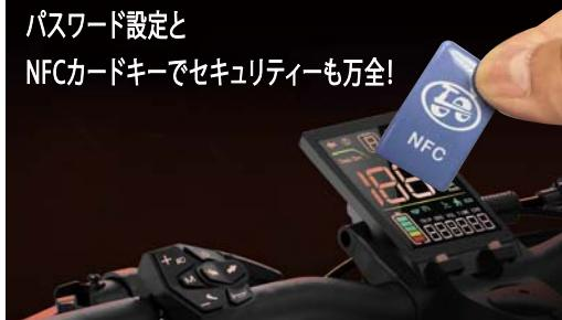
メイン電源をONしてもパスワード入力又は非接触型NFCカードキーがなければ走行可能になりません。モニターではバッテリー残量の他に区間距離、総走行距離、走行時間、エラー表示等の情報を確認出来ます。
